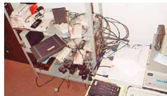
10 linhas telefônicas alugadas ligadas aos modems US Robotics 33.6kbps. Roteador Cisco 2516 (branco na mesa) é o que controlava todo o tráfego. Modem síncrono 64kbps (preto na segunda prateleira) fazia a ligação com Passo Fundo
