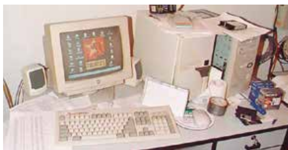
Computador à direita era o x.st.com.br o primeiro servidor de Erechim. Era o suficiente para as velocidades e volume de tráfego da época. Utilizava Linux e rodava os sistemas de proxy, FTP, IRC, email e autenticação, tudo isso num Pentium 90 com 32mb de RAM e HD SCSI com 320MB
